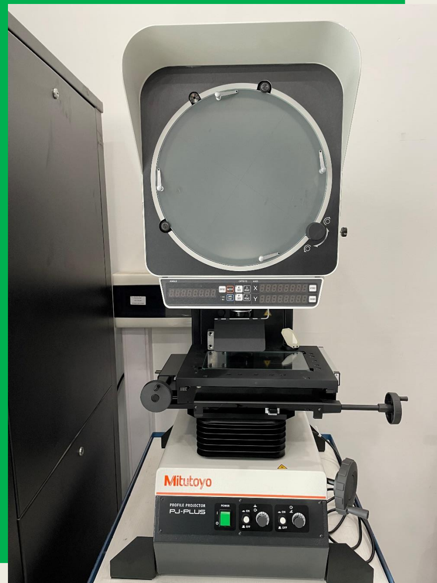
Proyector de perfiles Precisión hasta 0,001 mm
